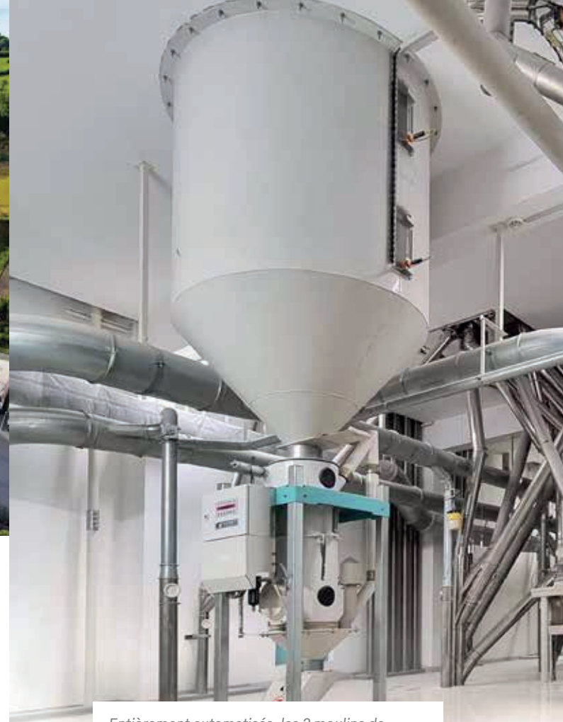
Entièrement automatisés, les 2 moulins de Saint-Martin-de-Saint-Maixent intègrent des technologies de pointe. Des capteurs mesurent en direct les taux d'humidité, de protéine et de cendres de la farine produite. La technique du DC Peeling, qui consiste à peler les premières écorces des grains de blé, qui lui permet d'être certifié Baby Food pour certains clients.
